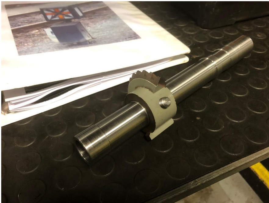
De holle as met daaraan bevestigd het kroontandwiel dat zorgt voor de omzetting van de horizontale naar verticale beweging. Door deze as loopt straks de buis met daarin de stroomkabel voor de verlichting van het sein.
