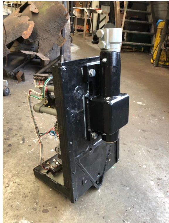
Links de originele NS-tekening van het gietstuk uit 1946 en rechts het eindresultaat van de daarop gebaseerde eigen constructie op de seinsteller gemonteerd.
